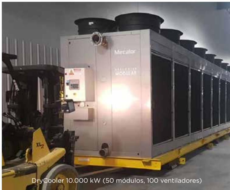
DryCooler 10.000 kW (50 módulos, 100 ventiladores)
